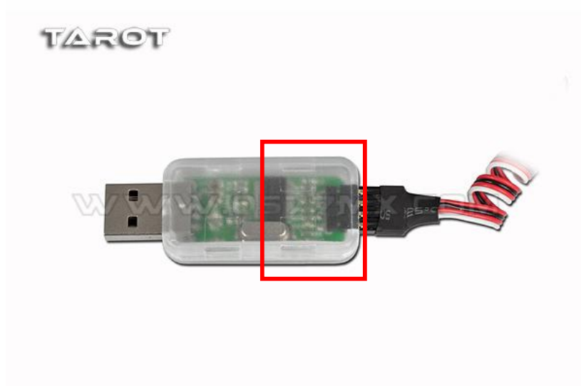
Подключение проводов к USB-донглу.
