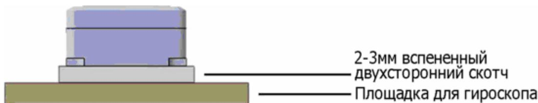
Установка на больших вертолётах или вертолётах с высокой вибрацией: используйте 2-3мм вспененный двухсторонний скотч с каждой стороны защитной демпфирующей пластины.
