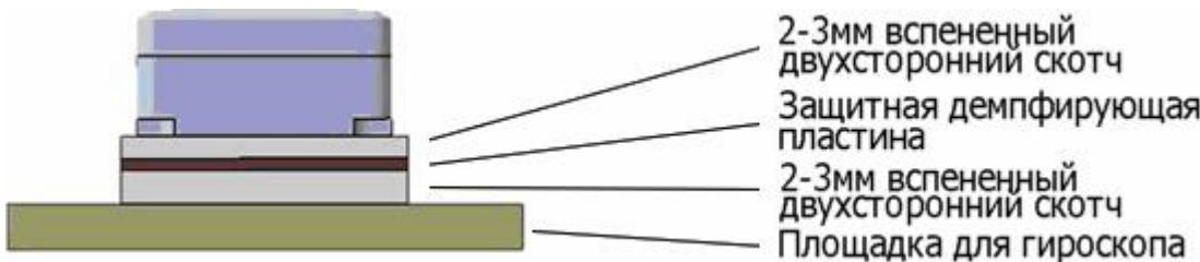
Есть три положения, которые могут быть использованы для крепления гироскопа (гироскоп должен быть настроен соответственно выбранному положению).
