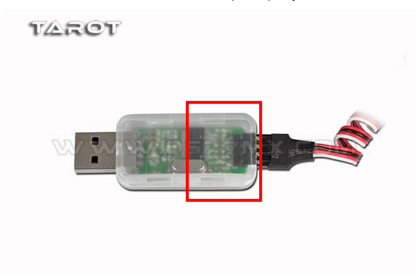
Подключение проводов к USB-донглу.
